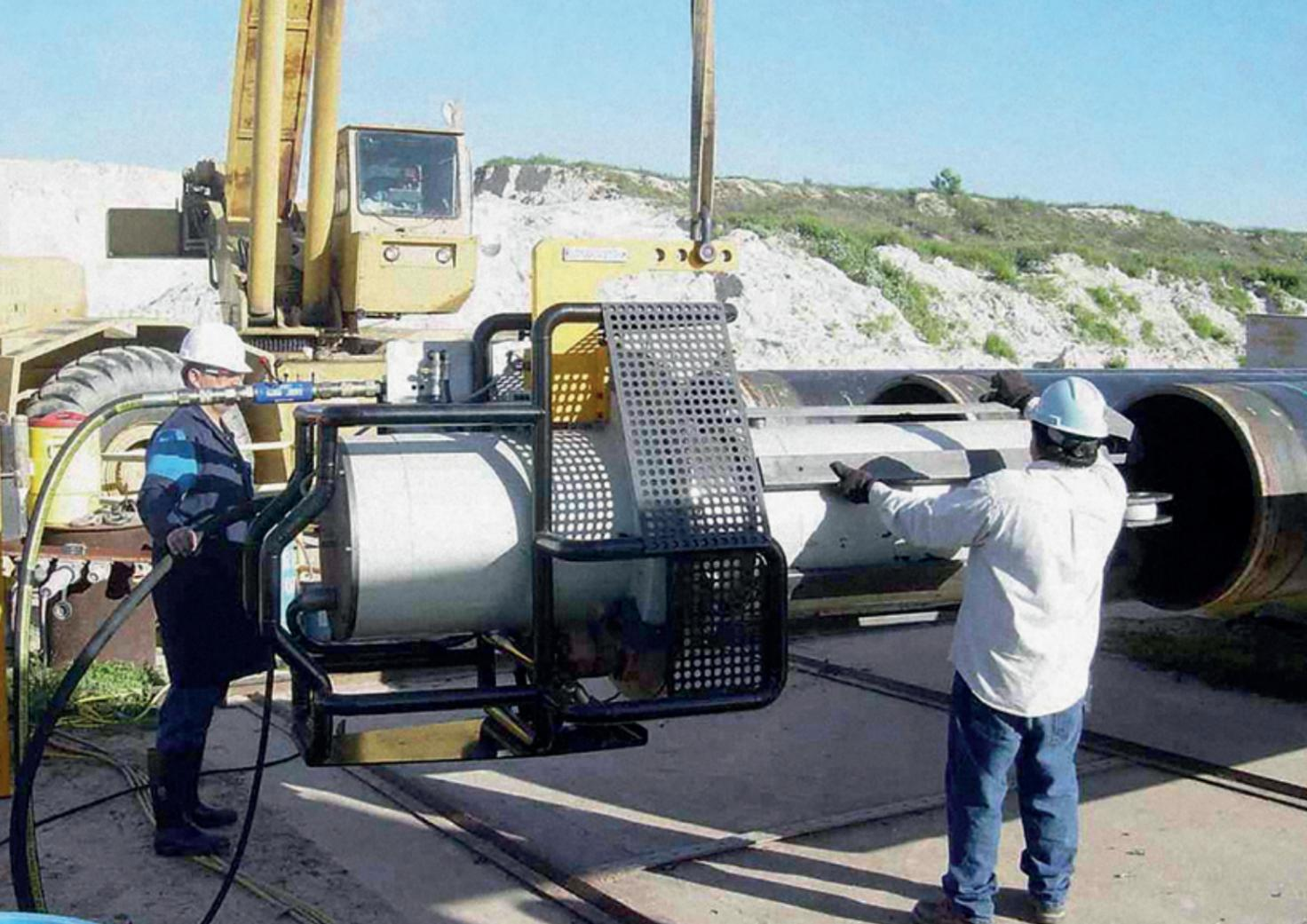
> Maintenance d'une plateforme pétrolière effectuée avec une machine de coupe PROTEM type TT
