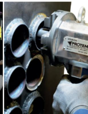
> Élimination de cordons de soudures pour des opérations de débouage avec la chanfreuse de tubes PROTEM US30CH
