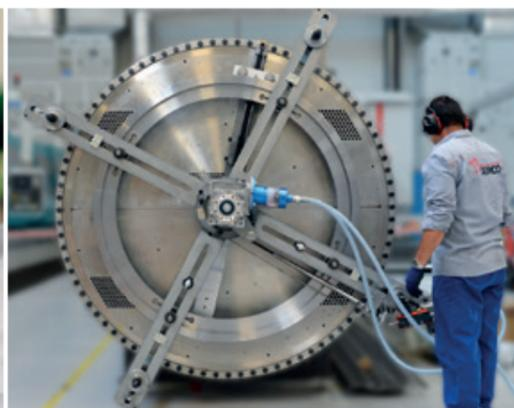
> Machines d'usinage portables permettant la maintenance et la réparation de brides et de vannes
