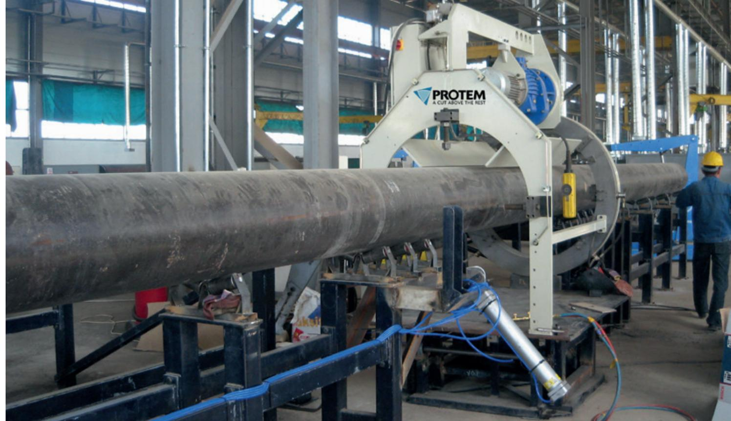
> Préfabrication de tubes sur site ou en atelier avec une machine à couper et chanfreiner PROTEM type TNO
