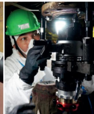
> Usinage sur site dans un environnement restreint et soumis à rayonnements ionisants avec une machine de surfacage type SERCO TU
