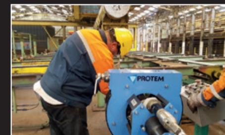
> Banc de chanfreinage mobile PROTEM BMFM pour l'usinage de tubes de fortes épaisseurs
